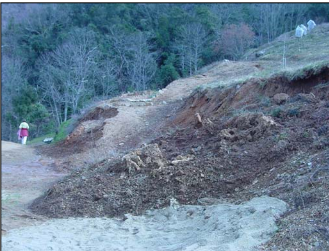
↑ Reynès – Glissement au lotissement « Le Clos de la Forge ». Délimitation du phénomène coté Ouest (photo de gauche) : zones d'arrachement successives (extension). Délimitation du phénomène coté Est (photo de droite) : bourrelets successifs (compression) Photographies RTM
