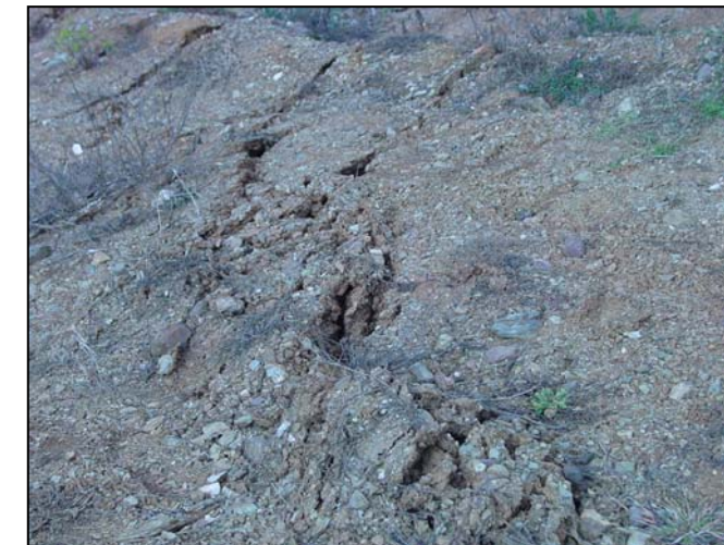
↑ Reynès – Glissement au lotissement « Le Clos de la Forge ». Délimitation du phénomène coté Ouest (photo de gauche) : zones d'arrachement successives (extension). Délimitation du phénomène coté Est (photo de droite) : bourrelets successifs (compression) Photographies RTM
