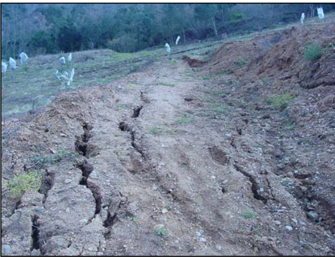
↑ Reynès – Glissement au lotissement « Le Clos de la Forge ». Délimitation du phénomène coté Ouest (photo de gauche) : zones d'arrachement successives (extension). Délimitation du phénomène coté Est (photo de droite) : bourrelets successifs (compression) Photographies RTM
