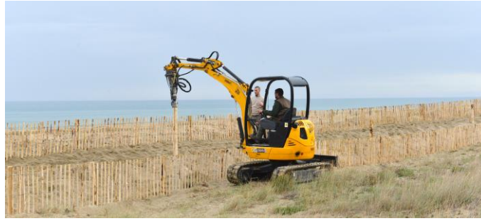
Exemple d'engin utilisé pour la pose de ganivelles (Crédit photo : Caroline MOREL FONTAINE)
