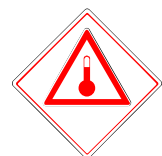
Marque pour les matières transportées à chaud
